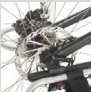
Standardmäßig mit vorderer Scheibenbremse.
