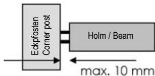
☞ Prüfen Sie den verbleibenden Abstand zwischen den Holmenden und der Führungsschiene. Er darf max. 10 mm betragen.
