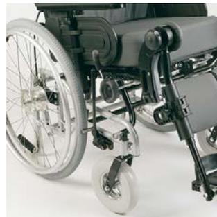
**Trommelbremse für 16", 22" und 24" Hinterräder**
