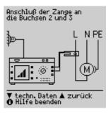
Mit einem an die Buchsen N (2) und L (3) angeschlossenen Zangen-Strom-/Spannungswandler z.B. WZ12C können in zwei Messbereichen (1 mA ... 10 A ~, 1 A ... 100 A~) Wechselströme gemessen werden.
