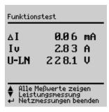
Mit der Taste (14) kann die Prüfdose spannungsfrei geschaltet oder mit der Taste ← (12) der Funktionstest beendet werden.
