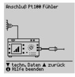
Mit einem Pt100- oder Pt1000-Fühler (Grundeinstellung), der an die Buchsen SL (1) und N (2) anzuschließen ist, können Temperaturen im Bereich -200 °C ... +850 °C gemessen werden.
