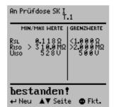
Hier können Sie die Messergebnisse der aktuellen Prüfung speichern, die aktuelle Prüfung in die entsprechende Protokollvorlage drucken, eine der bereits gespeicherten Prüfungen aufrufen (blättern: Option DBmed, siehe Kap. 12) sowie sämtliche gespeicherte Messergebnisse ausdrucken.
