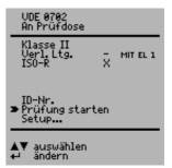
An Prüfdose Dies ist die Werkseinstellung. Für andere Anschluss-
